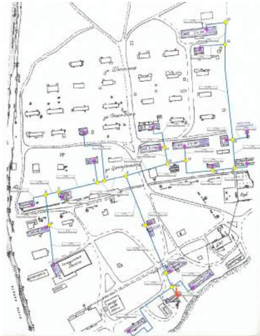
Рисунок 1. Зона действия централизованного теплоснабжения от котельной ООО «Колхоз Ударник» в СП «село Кострома»
